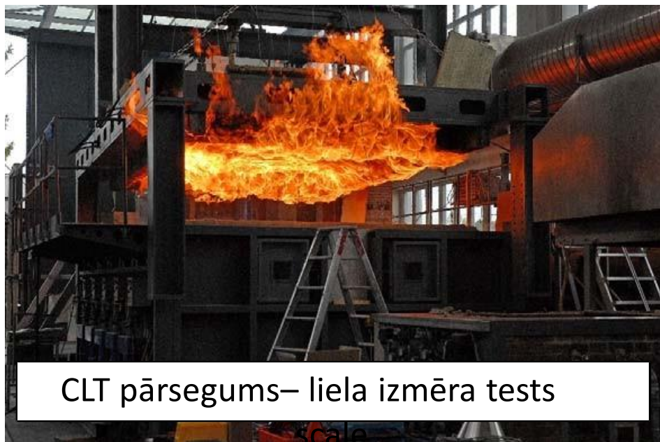
Norobežojošās funkcijas tests – liela izmēra tests
