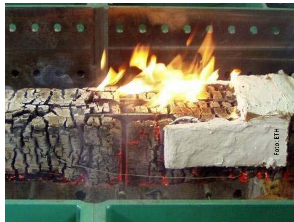
Savienojums ar iefrēzētajām tērauda plāksnēm
